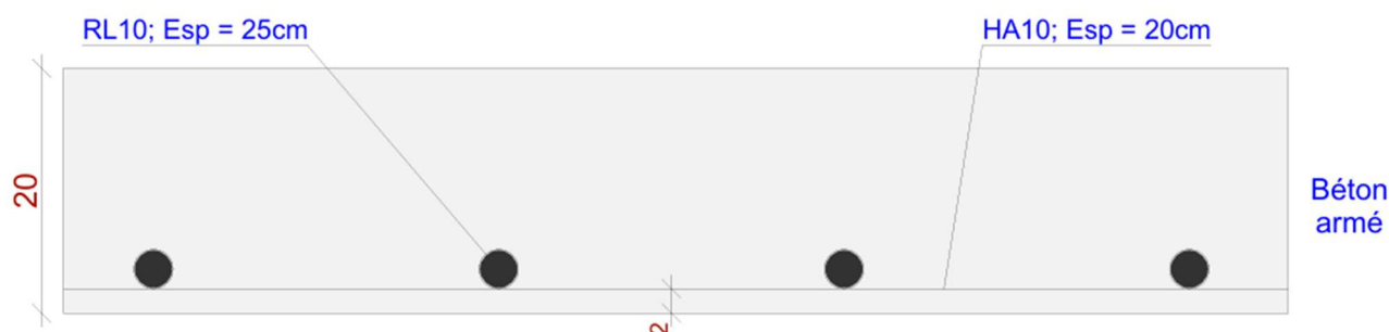
Coupe de principe de la dalle D1
